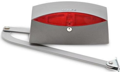
Motor za krilne kapije dužine do 5 metara i MAX do 600 kg po krilu (u zavisnosti od dužine kapije) – 230 V. Namjenjen je za kapije gde je mesto montaže motora udaljeno od ose kapije više od 15 cm, a manje od 47cm.
